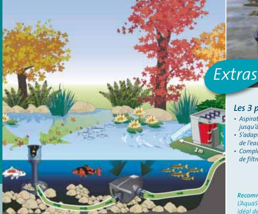
Représentation schématique : **AquaSkim** utilisé avec une pompe pour filtres et ruisseaux AquaMax Eco Premium
