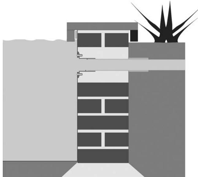
**NL** Met deze Multi-wanddoorvoer is het mogelijk om een onderwaterverbinding te maken in vijverfolie.
